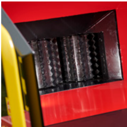
Rodillos de alimentación verticales con diseño forestal TP
