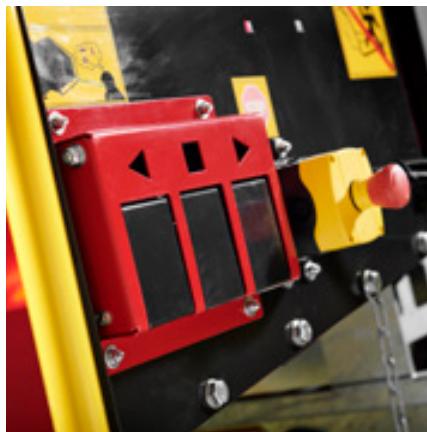
TP Easy Control función Reinicio – Inversión – Marcha
