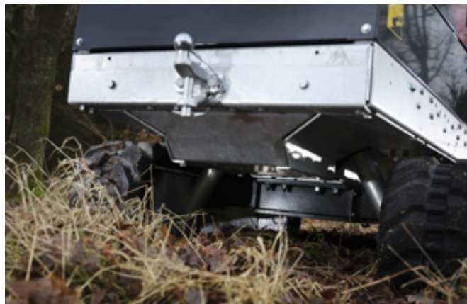
Garde au sol de 250 mm, entretien facile et protection renforcée du tuyau. Largeur de chenilles variable
