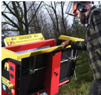
Manipulation facile de l'entonnoir renforcé et robuste grâce au ressort à gaz
